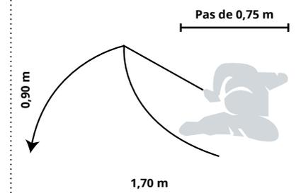
Fig 2 : Balayage avec un pas de 0,75 m
